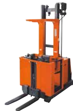
OME100M met extra hefmechanisme en OME100MW doorloop-uitvoering • Chassisbreedte 970 mm • Maximumcapaciteit 1000 kg • Verzamelhoogtes tot 6,3 m
