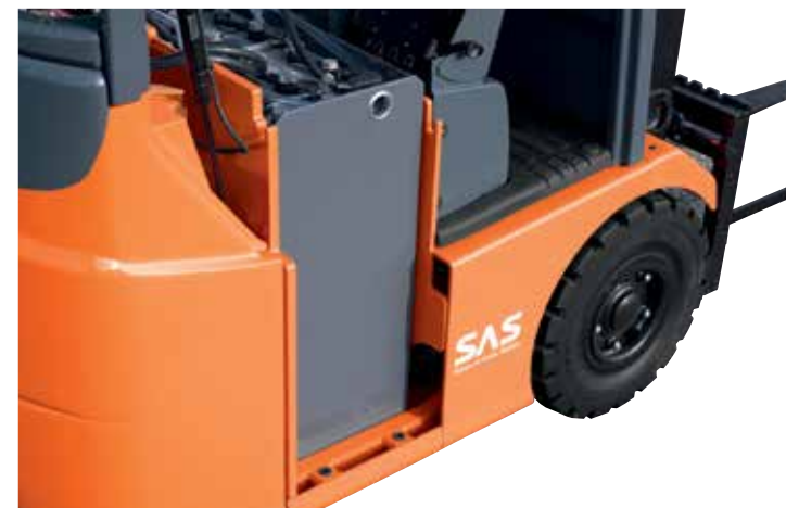
Standaard lage uitneembare batterij. Optioneel ingebouwd rollenbed voor snel wisselen
