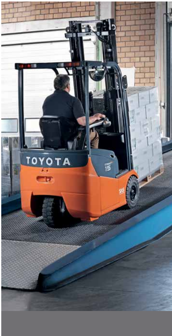
De clearview-mast biedt bestuurders uitstekend zicht op de lading en de werkomgeving
