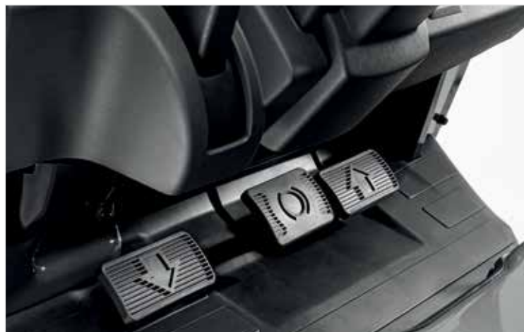
Verschillende pedaalindelingen naar voorkeur van de bestuurder (dubbele pedaalindeling is afgebeeld)
