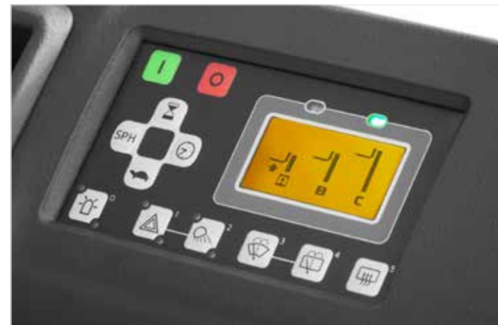
Vooraf ingestelde hefhoogte bespaart de bestuurder tijd en moeite
